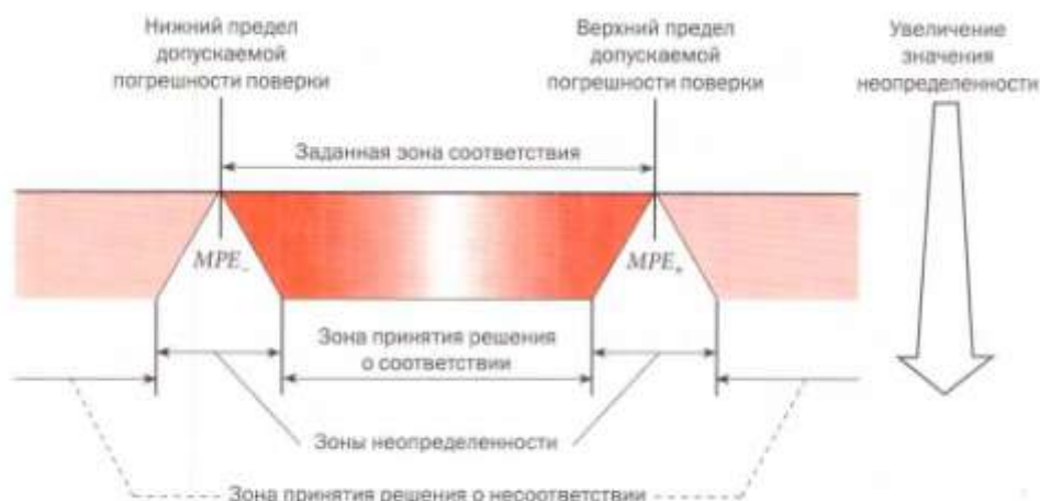
Рис. 7. Технические требования и неопределенность измерений (согласно ISO 14253-1)
